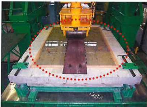
水張り試験体(新規製作)
